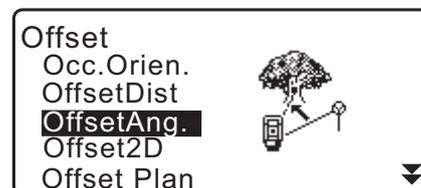
5. Visieren Sie den Versatzpunkt an und drücken Sie in der ersten Seite der OBS-Modusanzeige **[MEAS]** (MESSEN), um die Messung auszulösen.
