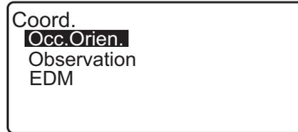
4. In <Coord> wählen Sie „Observation“ (Beobachtung). Das Drücken von **[MEAS]** (MESSUNG) startet die Messung und der Koordinatenwert des Ziels wird angezeigt. Drücken Sie **[STOP]**, um die Messung abzubrechen.
