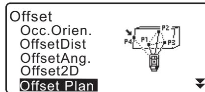
4. Düzlemin üzerindeki birinci noktaya (P1) nişan alın ve ölçüme başlamak için **[MEAS]** (ÖLÇ) tuşuna basın. Ölçüm sonuçları görüntülenir. **[YES]** (EVET) tuşuna basın.
