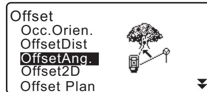
5. Ofset noktasına nişan alın ve ölçüme başلامak için OBS (GÖZLEM) modu ekranının birinci sayfasında **[MEAS]** (ÖLÇ) tuşuna basın.
