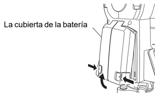
2. Introduzca la batería en la dirección indicada por la flecha del lateral de la batería.
