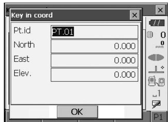
4. Seleccione una referencia de replanteo en la primera pantalla del paso 3 y pulse **[Aceptar (OK)]** para que aparezca <Replantear coordenadas (Set out Coords)>.
