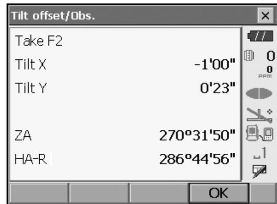
8. Pulse **[(Aceptar) OK]** y gire la parte superior del instrumento y el telescopio 180°.
