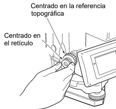
4. Ajuste los tornillos del pie de nivelación para centrar la referencia topográfica en el retículo de la plomada óptica.
