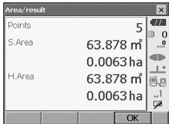
6. Pulse [**Aceptar (OK)**] para volver a <Área/Introducir coordenadas (Area/key in coord.)>.
