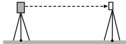
3. Mientras la pantalla del modo Observación esté activa y el telescopio esté en la cara 1, apunte al centro del blanco correctamente y lea el ángulo horizontal A1 y el ángulo vertical B1.
