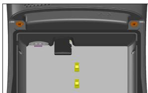
5. Recoloque a bateria e depois recoloque a tampa da bateria.
