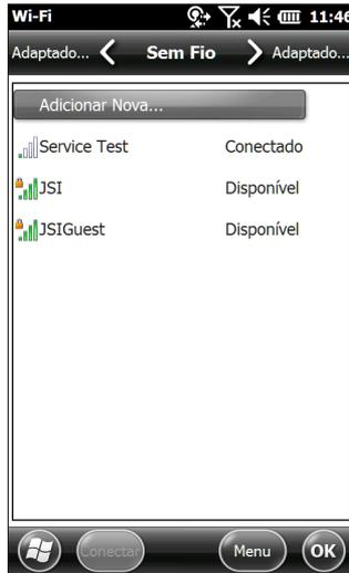
3. Toque na rede que você deseja se conectar. Se você quiser adicionar uma nova rede, selecione *Adicionar Nova* no topo da lista.
