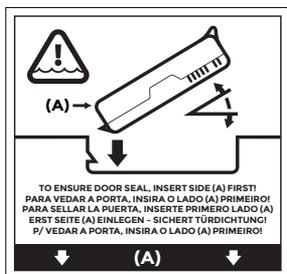
Segure a bateria de maneira que a aba preta na borda frontal da bateria fique para cima e voltada para a trava da tampa (essa aba ajuda a retirar a bateria). Insira a borda posterior primeiro, empurrando-a gentilmente debaixo dos dois contatos de bateria. Gire a borda frontal para baixo até que esteja na posição correta.
