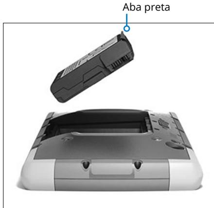
4. Recoloque a tampa e pressione-a até a trava se encaixar na posição travada.
