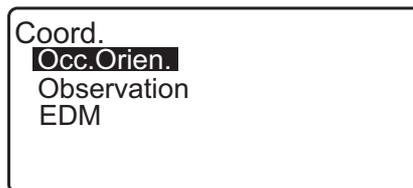
4. In <Coord> (Coordinate), selezionare "Observation" (Osservazione). Premendo **[MEAS]**, lo strumento avvia la misurazione e sul display vengono visualizzate le coordinate dell'obiettivo trapiantato. Premere **[STOP]** per interrompere la misurazione della distanza.
