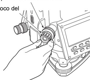
4. Regolare le viti del piede di livellamento per centrare il punto di stazionamento nel reticolo del piombo ottico.
