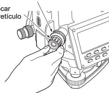
4. Ajuste os parafusos da base de nivelamento para centrar o ponto de referência no retículo do prumo ótico.
