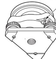
4. Regule os parafusos de ajuste até que a tensão de aperto dos três parafusos seja igual para alinhar a bolha de ar no meio do círculo.
