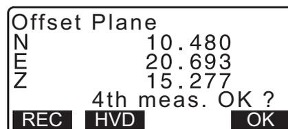
7. Depois de concluir a medição, prima **[OK]** no ecrã do passo 6 para voltar a <Offset> (Compensação).
