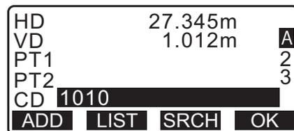
Prima **{ESC}** para continuar a medição sem guardar os resultados de medição do 2.º alvo ou de linha em falta.
