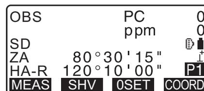
Quando a medição é iniciada, as informações EDM (modo de distância, valor de correção da constante do prisma, fator de correção atmosférica) são apresentadas por uma luz intermitente.
