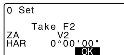
5. Rode a parte superior 180° e fixe-a. De seguida, coloque o telescópio na posição de Face 2 e aponte com precisão para o mesmo alvo.
