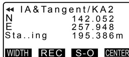
7. Nos ecrãs para determinar o ponto KA1, o ponto KE1, o ponto KE2 e o ponto KA2, prima **[CENTER]** (Centro) para aceder às definições da estaca da linha central. Introduza a medição ao longo da via (medição ao longo da via até estaca CL) e prima **[OK]** para calcular as coordenadas da estaca da linha central arbitrária. Os resultados são apresentados neste ecrã.
