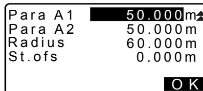
6. Prima **[OK]** no ecrã apresentado no passo 5 para calcular as coordenadas e a distância de seguimento do ponto KA1, ponto KE1, ponto KE2 e ponto KA2. Os resultados são apresentados nos ecrãs apresentados. Prima **[>]/[<]** para comutar entre <IA e Tangente/KA1>/<IA e Tangente/KE1>/<IA e Tangente/KE2>/<IA e Tangente/KA2>.
