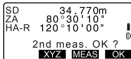
7. Depois de concluir a medição, prima **[YES]** (Sim) para voltar a <Offset> (Compensação).
