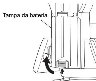
2. Inspeccione o lado do terminal da bateria, insira a bateria conforme demonstrado na imagem.
