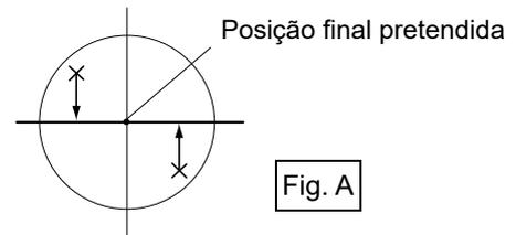
(2) Desaperte ligeiramente o parafuso superior (inferior) e aperte o parafuso inferior (superior). Certifique-se de que a tensão de aperto de ambos os parafusos é idêntica. Continue a ajustar até que o raio laser se encontre na linha horizontal do alvo.
