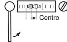
6. Rode a parte superior do aparelho e continue com os ajustes até que a bolha permaneça centrada em todas as posições em que se encontre a parte superior do aparelho.
