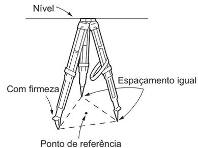
2. Coloque o aparelho sobre a cabeça do tripé.
