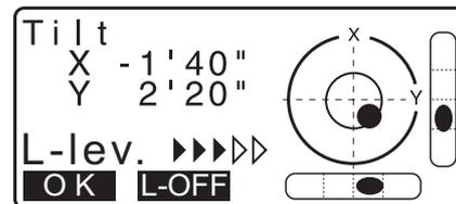
4. Utilizando os parafusos da base de nivelamento, ajuste a posição do aparelho sobre o tripé até que o raio laser esteja alinhado com o centro do ponto de referência.
