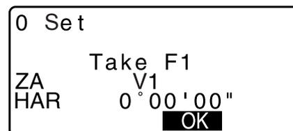
4. Aponte com precisão para um alvo nítido a cerca de 30 m de distância na horizontal com o telescópio na Face 1.
