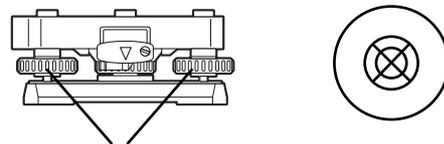
Parafusos da base de nivelamento
