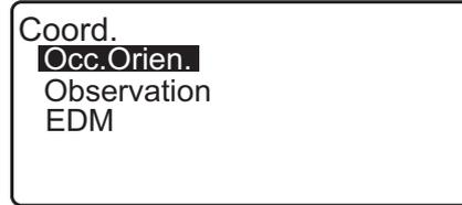
4. На экране <Coord> (Координаты) выберите «Observation» (Замер). Нажатие **[MEAS]** запустит измерение, будет отображено значение координат цели. Нажмите **[STOP]** для выхода из режима измерения.
