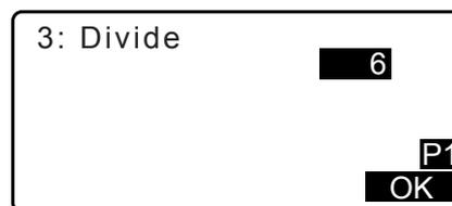
6. Координаты каждой делящей точки отображаются на идущих подряд экранах. Для переключения между экранами результатов нажмите **[▶]/[◀]**. Нажмите **[OK]** для возврата к экрану на шаге 3 и продолжите измерения при необходимости.
