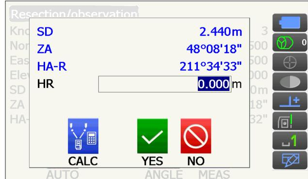
**[AUTO]** s'affiche à partir du 3e point. Appuyer sur **[AUTO]** permet de faire pivoter l'instrument vers le point suivant et de lancer une mesure automatique.
