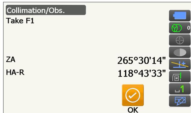
6. Lorsque le télescope se trouve en position Face 2, visez correctement le centre de la cible et appuyez sur **[OK]**.
