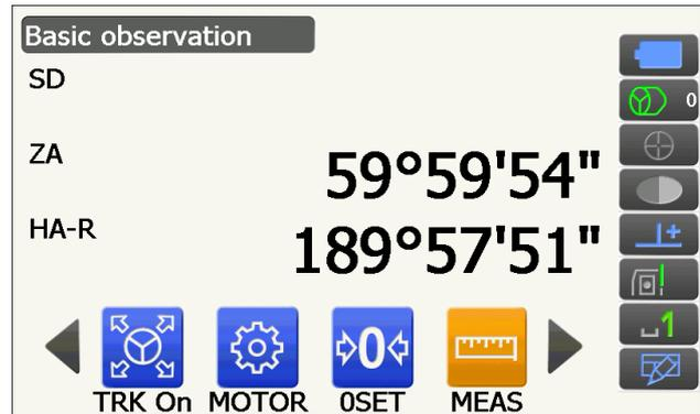
La mesure démarre, et les données de mesure de distance (SD), l'angle vertical (ZA), et l'angle horizontal (HA-R) s'affichent.
