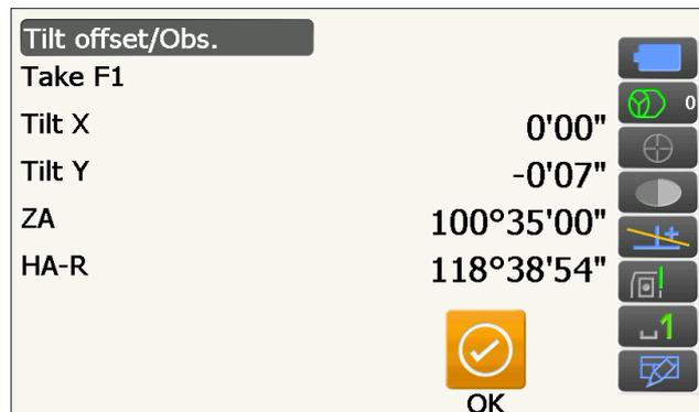
5. Appuyez sur [OK]. La partie supérieure de l'instrument et le télescope pivotent de 180° depuis la position actuelle. Patientez quelques secondes jusqu'à ce que l'écran se stabilise.
