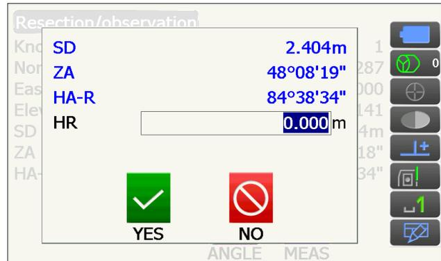
6. Répétez les procédures 4 à 5 de la même manière pour les points suivants. Lorsque la quantité minimale de données d'observation nécessaires pour le calcul est obtenue, **[CALC]** s'affiche.
