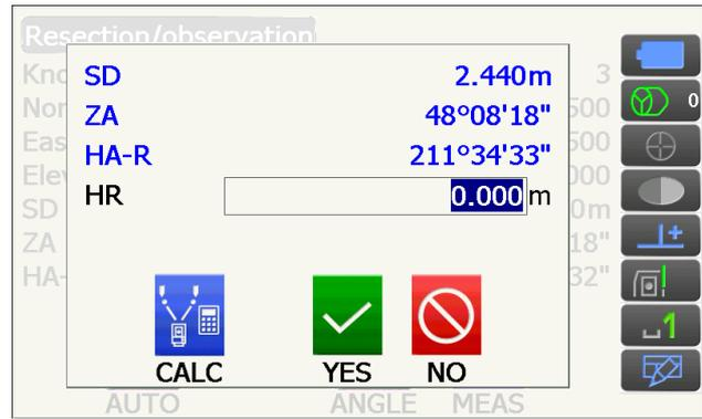
**[AUTO]** será exibido a partir do 3º ponto. Premir **[AUTO]** irá rodar o aparelho para o próximo ponto e iniciar a medição automática.
