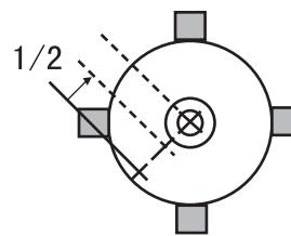
4. Снимите крышку сетки оптического отвеса.
