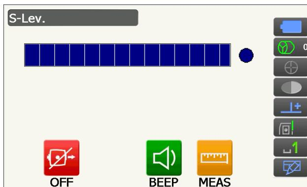
При нажатии [**S-LEV**] на приборе отображается индикатор интенсивности света.
