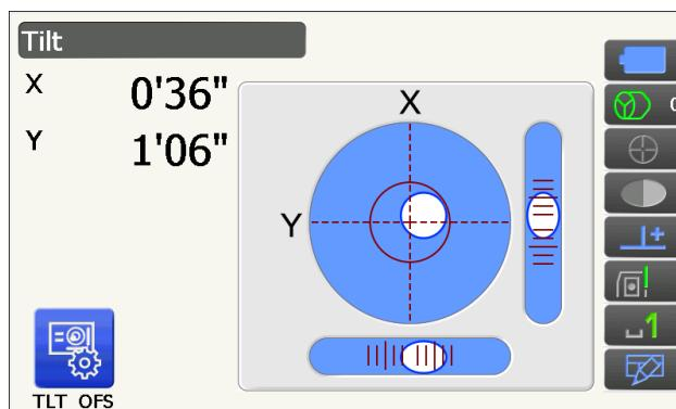
4. Используя винты для выравнивания ножек, поместите «●» в центр круглого уровня. Сначала поворачивайте прибор, чтобы зрительная труба расположилась параллельно линии, образованной юстировочными винтами ножек А и В. Затем установите значение угла наклона на  $0^\circ$  с помощью винтов А и В по оси Х и с помощью юстировочного винта С по оси Y.
