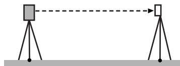
3. Когда отображается экран режима замеров и зрительная труба находится в положении Face 1, визируйте центр призмы надлежащим образом и снимите показания горизонтального угла A1 и вертикального угла B1.
