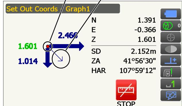
Разметочная точка Положение работающего с мачтой
