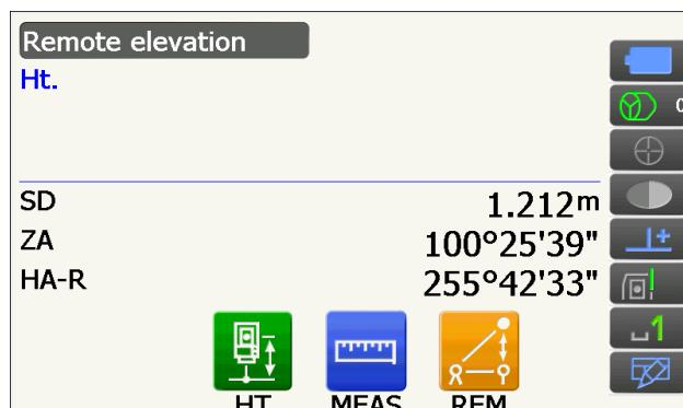
4. Визируйте объект, затем нажмите [REM] для начала измерения REM. Высота от земли до объекта будет отображаться в поле «Ht.». Нажмите [STOP] для остановки измерения.
