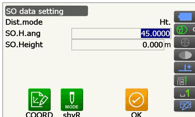
5. Нажмите [H.TURN] для автоматического поворота прибора до тех пор, пока отображаемый угол для разметочной точки не станет  $0^\circ$ .
