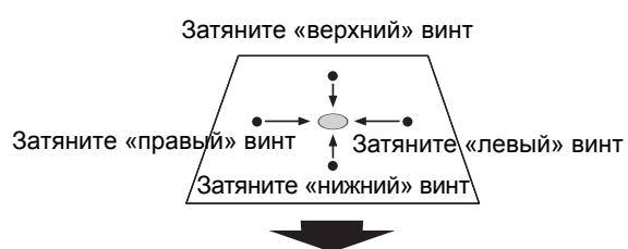
Регулировочная крышка лазерного отвеса обращена к пользователю
