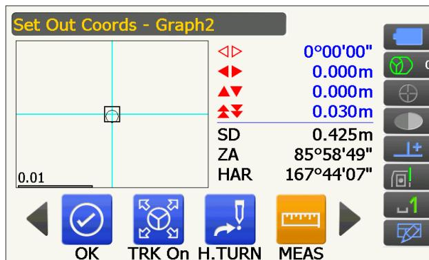
6. Нажмите [OK] для возврата на экран <Key in coord> (Ввод коорд.). Задайте следующую разметочную точку для продолжения разметочных измерений.
