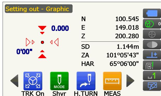
8. Нажмите {ESC} для возврата к экрану <Setting out> (Разметка). Задайте следующую разметочную точку для продолжения разметочных измерений.
