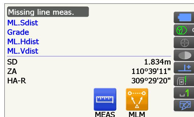
4. Визируйте следующую цель и нажмите **[MEAS]** для продолжения замеров. Таким способом могут быть измерены длина наклонной, уклон, горизонтальное расстояние и перепад высот между несколькими точками и начальным положением.
