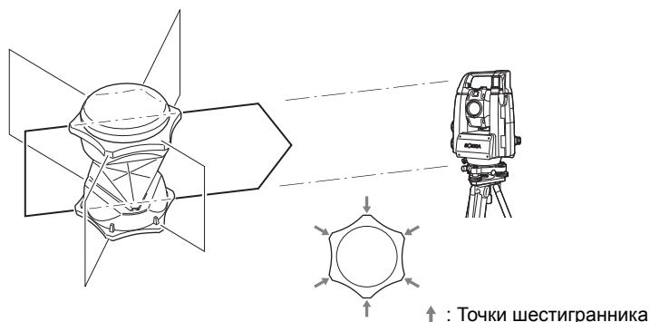
При использовании ATP1SII, призма 360° должна быть установлена так, чтобы пара диаметрально противоположных отметок на верхней части призмы была совмещена с направлением визирования прибора.
