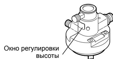
2. Выровняйте прибор и проверьте положение пузырька на трубчатом уровне.
