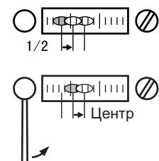
6. Поворачивайте верхнюю часть прибора и продолжайте регулировки до тех пор, пока пузырек не будет оставаться в центре при любом положении верхней части.
