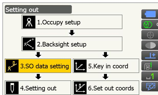
В дальномерном режиме, соответствующем вашим требованиям к измерениям, введите внутренний угол между базовой точкой и разметочной точкой в «SO.H.ang» (Гор. разм. угол) и введите расстояние (длину наклонной, горизонтальное расстояние или разницу по высоте) от прибора до положения, которое будет задано в «SO.Sdist» (Разм. длина наклонной). Нажмите [OK], чтобы задать введенные значения.
