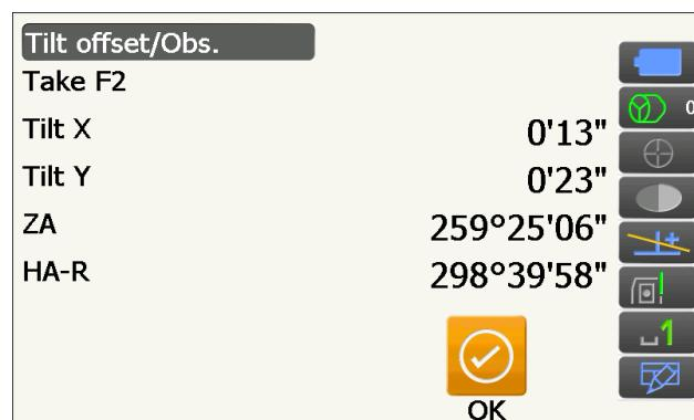
7. Отобразится новая измеренная константа поправки наклона.
