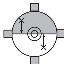
Если точка съемки находится на непрерывной (пунктирной линии): Слегка ослабьте правый (левый) регулировочный винт и затяните левый (правый) регулировочный винт на такое же число оборотов, чтобы переместить точку съемки в точку в центре оптического уровня.
