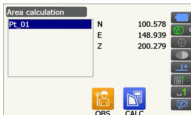
4. Повторите шаги с 2 по 3 до тех пор, пока не будут измерены все точки. Точки на замкнутой поверхности замеряются по часовой стрелке или против часовой стрелки.
