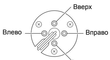
Винты точной регулировки
