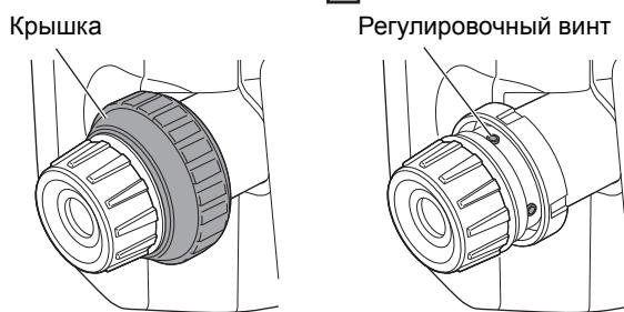
5. Используйте 4 регулировочных винта оптического отвеса для регулировки оставшейся половины отклонения, как показано ниже.
